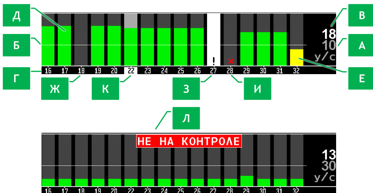
Рисунок 13 Диаграмма контроля высева в режиме контроля «Поток»
